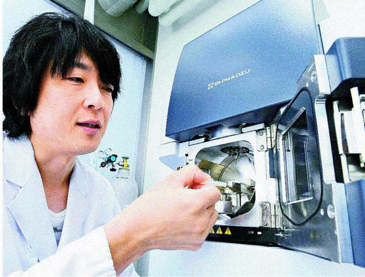
直径0・14ミリ。極細の針が、微量な検体を刺し、針に高電圧が加わると成分解析が始まる。判定にかかる時間は約2分。2006年、山梨大クリーンエネルギー研究センター教授（当時）の平岡賢二（75）が開発した質量分析技術「探針エレクトロスプレーイオン化法（PESI）」を初めて見た同大医学部教授、竹田扇（50）は直感した。「迅速で簡便。医療の現場に生かせるのではないか」。活用法の模
