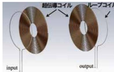
図2 ワイヤレス電力伝送回路
