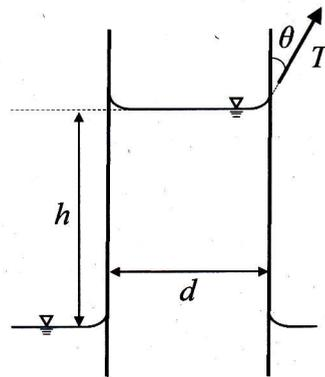
図 1 : 水面に挿入した細い円管
