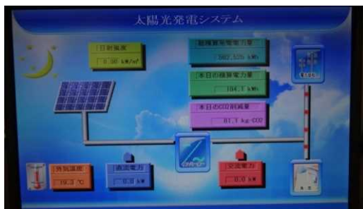
屋内壁掛液晶モニター
