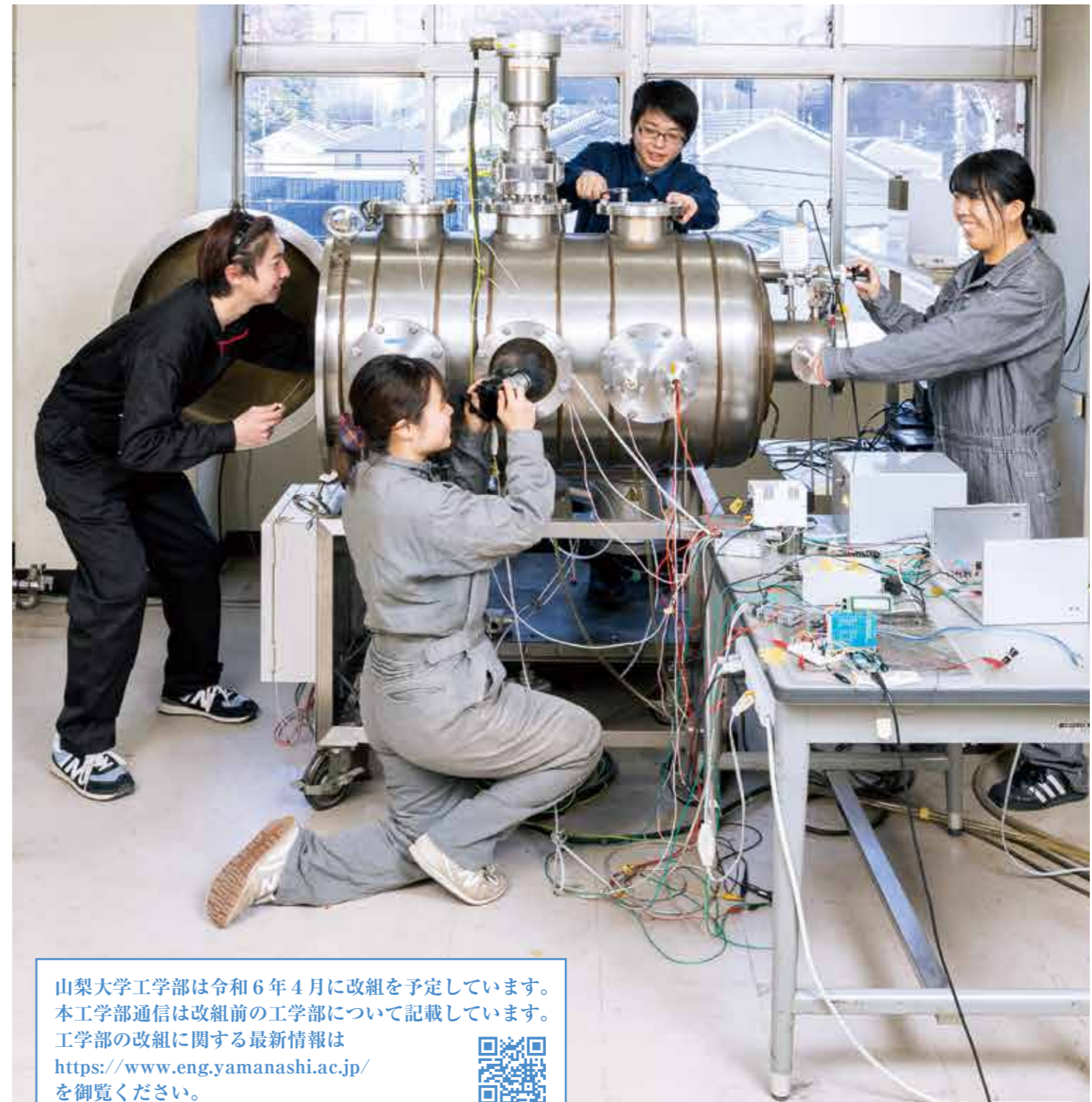
人工衛星用小型ロケットの真空中作動試験準備の様子
